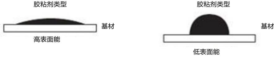
此图解展示了表面能对胶粘剂粘接性能的影响。高表面能材料会被更好的浸润，从而实现较高的粘接强度。
